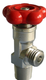
Ventil für gebrauchtes SF 6 mit einem SO 2 -Gehalt ≥ 500 ppm v nach DIN 477 Nr.8 - 1" Edelstahl
