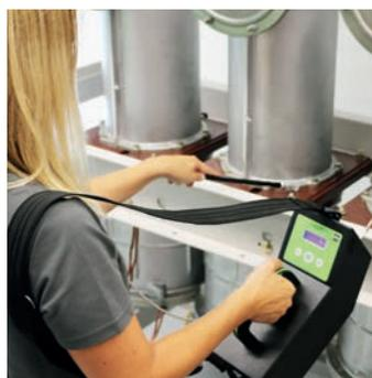
La rallonge du capteur de mesure (incluse dans la livraison), qui peut être installée entre l'appareil et le capteur de mesure, si nécessaire, permet la mesure sur les points de mesure difficiles à accéder.
