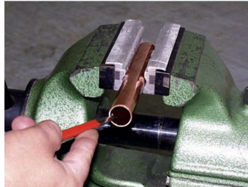
2. Rohr innen und außen entgraten
