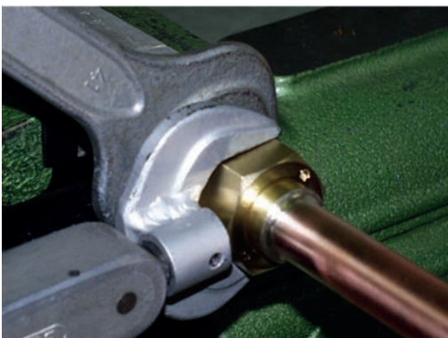
11. Kurzes, kräftiges Anziehen der Überwurfmutter mit Gegenhalten (Drehmoment beachten)
