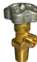
Válvula para gas SF 6 nuevo*, gas SF 6 reacondicionado, así como gas SF 6 usado con un contenido de SO 2 ≤ 250 ppm v según DIN 477 no. 6 W21,8 x 1/14" latón
